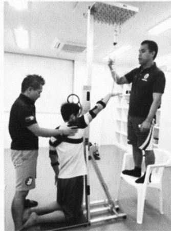
図 11. 計測者によるチェーンの角度（フォースゲージの牽引角度）の適正姿勢保持の判定の様子
