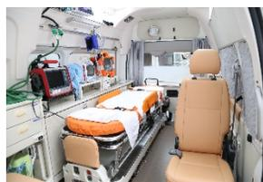
救急車の機能は、通常の救急車が備えている機能はもちろん、加えて「モニター」、「半自動除細動器」、「人工呼吸器」も搭載。
