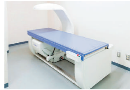
骨密度測定と脊椎骨折分析を組み合わせることで、より正確な骨折リスクを診断できるX線骨密度測定装置
