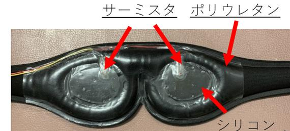
図2. サーモグラフィーでの温度測定
